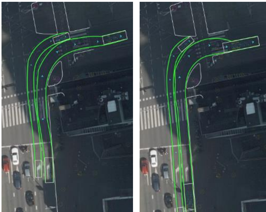
Rijcurve simulatie van personenauto - bestelbus (links) en personenauto - vrachtwagen (rechts)
