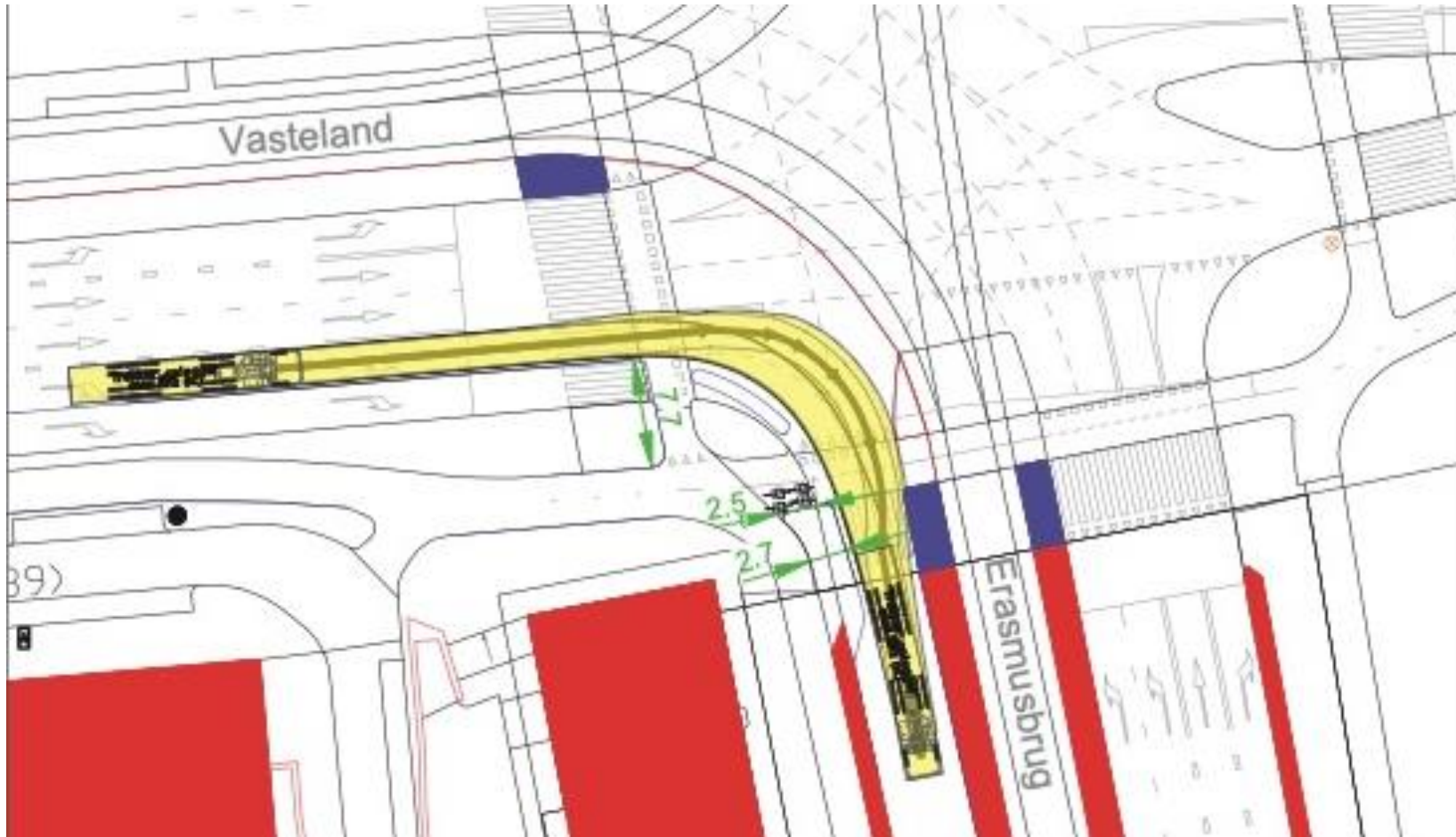
trekker met oplegger (vrachtwagencombinatie) is maatgevend
